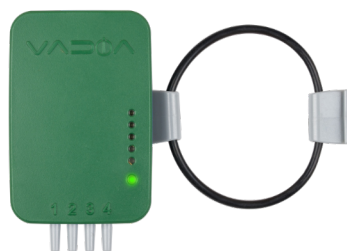
Kontrollleuchte als Statusanzeige und wasserdichter USB- Anschluss
